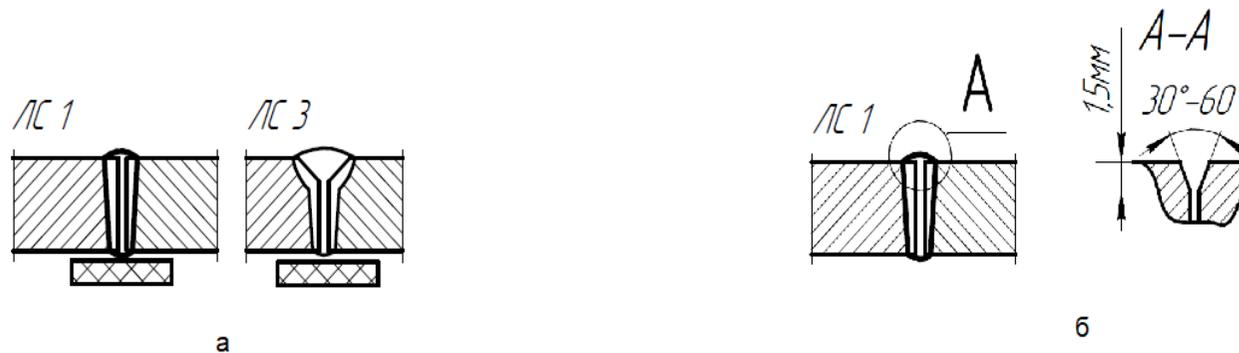
Рисунок ДВ.1 – Подготовка сварных соединений и применимость ЛДГС для стыковых соединений
